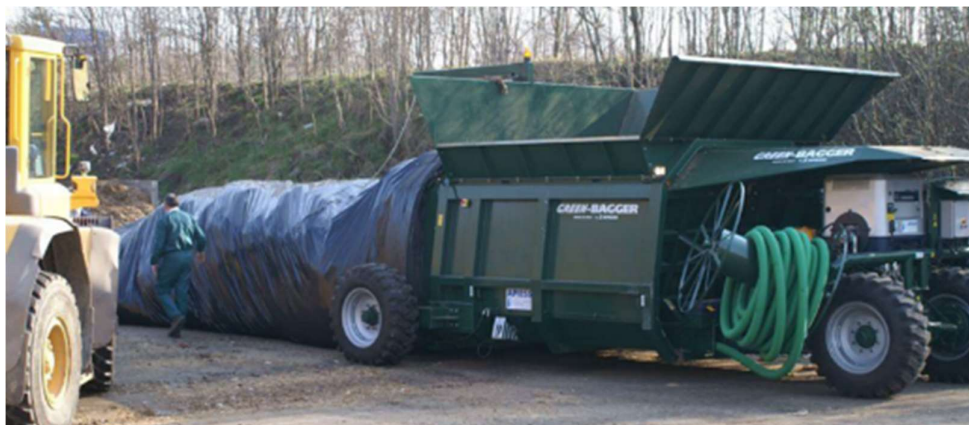
Rysunek 32 Prasa do liniowego napełniania rękawów foliowych
